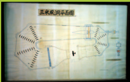
木製巨大風洞の平面図。飛行機が描かれている。
