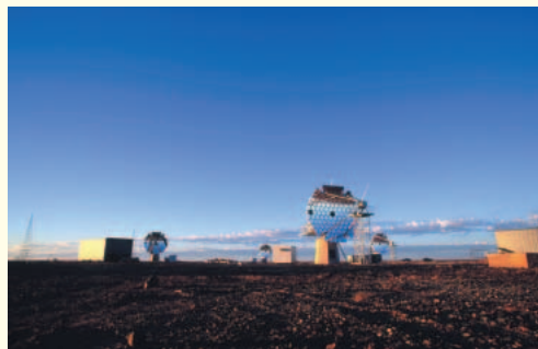
オーストラリアの砂漠に設置された空気チェレンコフ望遠鏡（CANGAROO）：天体からの超高エネルギー・ガンマ線が大気に入射したときに発する光を、4台の望遠鏡で捉える
