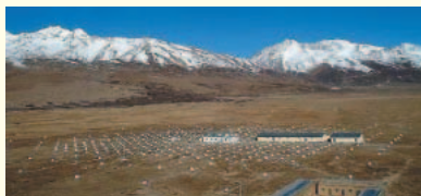
チベットの砂漠に展開されている空気シャワー・アレイ：宇宙線が大気に入ったときに起こす空気シャワーを地上に展開した測定器で直接検出する
