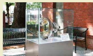
光電子増倍管。目には見えない弱い光をとらえることのできる超高感度光センサー
