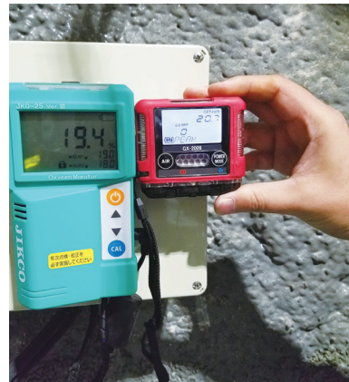
ガスセンサーはメンテナンスをしないと誤作動・誤表示をすることがあり、巡視の際にも機器の動作やメンテナンス状況を確認しています。
