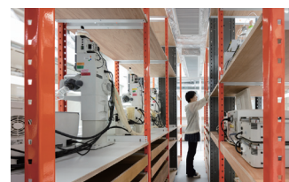
図 3 可変棚や配線ラックを備えた機器ラックとメンテナンス通路
