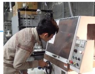
金属塊を高速精密切断機で加工
