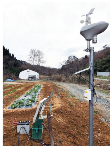
開発した電柵通電監視システム
