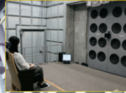
主に低音の実験をするときに使う音響実験室。計16個のスピーカーが壁に埋め込まれています。米村先生が音の評価実験をするときは、音を被験者に聞いてもらい、その時の不快感が1~10といった数字のどこに当てはまるか評価をしています。
