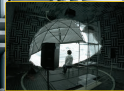
三次元的に音を出せる音響実験室。壁や天井、そして床に吸音するグラスウールが敷き詰められ、部屋の中の音が反射しないようになっています。部屋に置かれたドーム型のスクリーンに映像を映し出しながら被験者に音を聞いてもらい、視覚情報による音の印象の変化なども実験しています。
