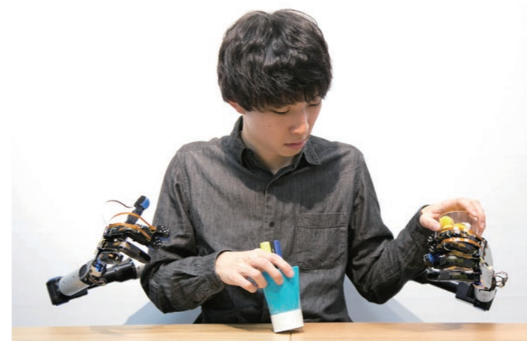
【MetaLimbs】 提供：東京大学 稲見・門内研究室&KEIO MEDIA DESIGN 足を使うことで阿修羅像のように第3、第4の腕を操ることができる装置。より使いやすく、身体化しやすい装置の開発が続けられている。
