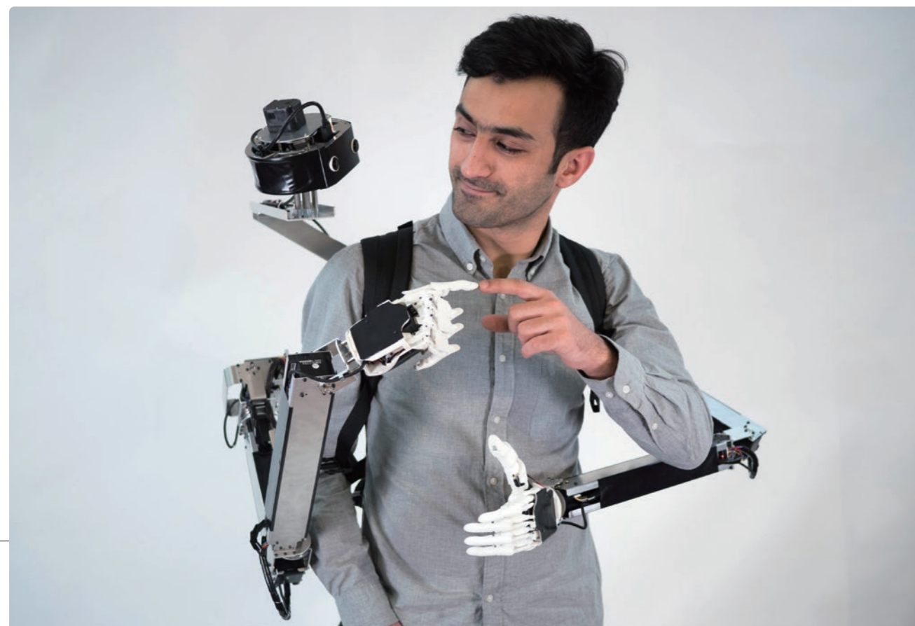
【Fusion】 提供：東京大学 稲見・門内研究室&KEIO MEDIA DESIGN 遠隔操作により、離れた場所の人と二人羽織ができる。二人羽織している人とされている人の親密感が高まるため、コミュニケーションメディアでもあるという。
