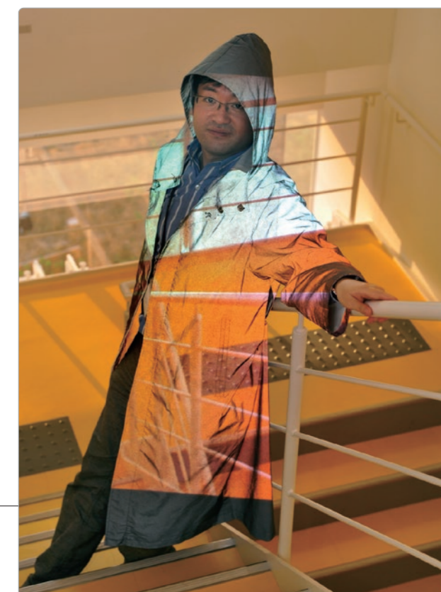
【光学迷彩マント】 撮影：Ken Straiton 入射した光を漏らさず真っ直ぐ返す再帰性反射材を使って透明になるマントを開発。SNS上の東京大学公式アカウントで紹介されると話題を呼び、アカウント史上最大のヒットとなった。
