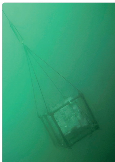
（写真左）開発したプラスチックの実海洋分解試験に臨む伊藤耕三 教授／（写真中央）実海洋分解試験中の様子。生分解性プラスチックは、分解中も無害でマイクロプラスチック化しない。／（写真右）実海洋分解試験後のプラスチックの様子。タイヤの材料となるゴムの開発では、吉江尚子 教授の研究成果を用い、破壊強度2倍以上、生分解速度10倍以上の両立に世界で初めて成功した。
