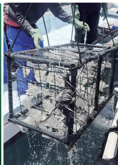
（写真左）開発したプラスチックの実海洋分解試験に臨む伊藤耕三 教授／（写真中央）実海洋分解試験中の様子。生分解性プラスチックは、分解中も無害でマイクロプラスチック化しない。／（写真右）実海洋分解試験後のプラスチックの様子。タイヤの材料となるゴムの開発では、吉江尚子 教授の研究成果を用い、破壊強度2倍以上、生分解速度10倍以上の両立に世界で初めて成功した。
