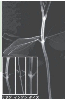
図1 中性子線によるササゲの水分像。白いところほど水分量が多い。
