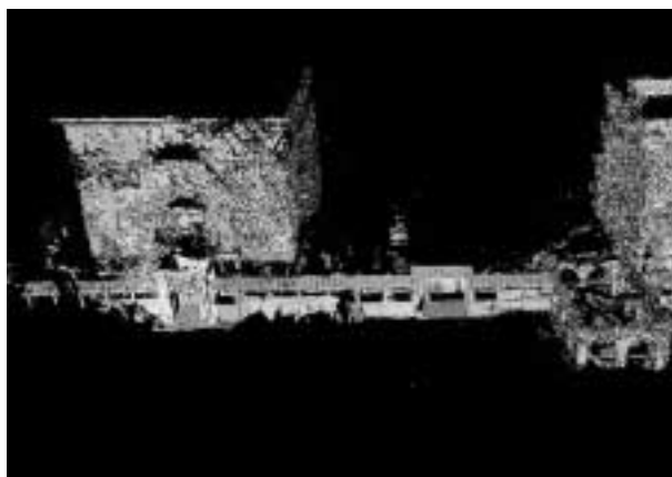
レーザー測定データによって再現された旧駒場寮建物(2) (生産技術研究所池内研究室提供)
