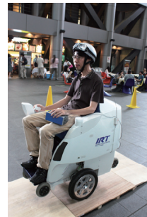
工学部2号館ラウンジで人々の目を引いていた、高齢者支援用の「パーソナルモビリティ(一人乗り自動ロボット)」。セグウェイのように二輪で移動。
