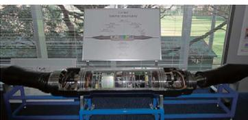
旧型の海底地震計は長さ2.2mと巨大ですが、現在は長さわずか10cmと超小型（地震研究所1号館）
