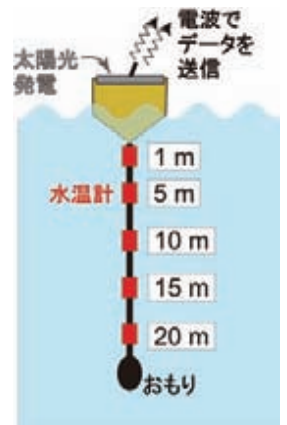
水温観測装置のしくみ
