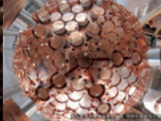
零下100℃に冷却した約1トンの液体キセノンを用いて、宇宙の源とも考えられるダークマター（暗黒物質）を直接観測するための検出器。将来は20トン級クラスの多目的検出器に拡張する予定です。
