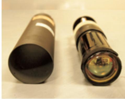
上の光電子増倍管は高感度の光センサ。右のミュオン検出器は、光電子増倍管とシンチレータ（放射線で発光する蛍光物質）を組み合わせたものです。右上は原子核乾板という特殊なフィルムを用いて捉えられたミュオンの飛跡。
