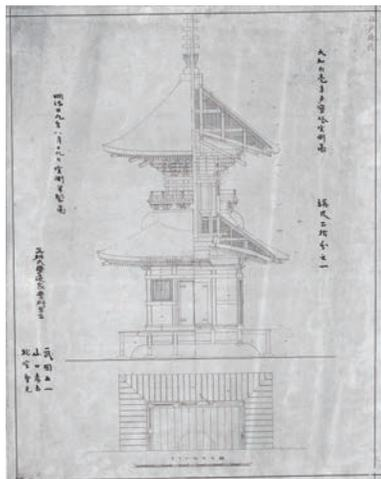
図5 「大和大毫寺多宝塔実測図 明治29年8月19日実測并製図 工科大学造家学科学学生武田五一、山口孝吉、松室重光」
