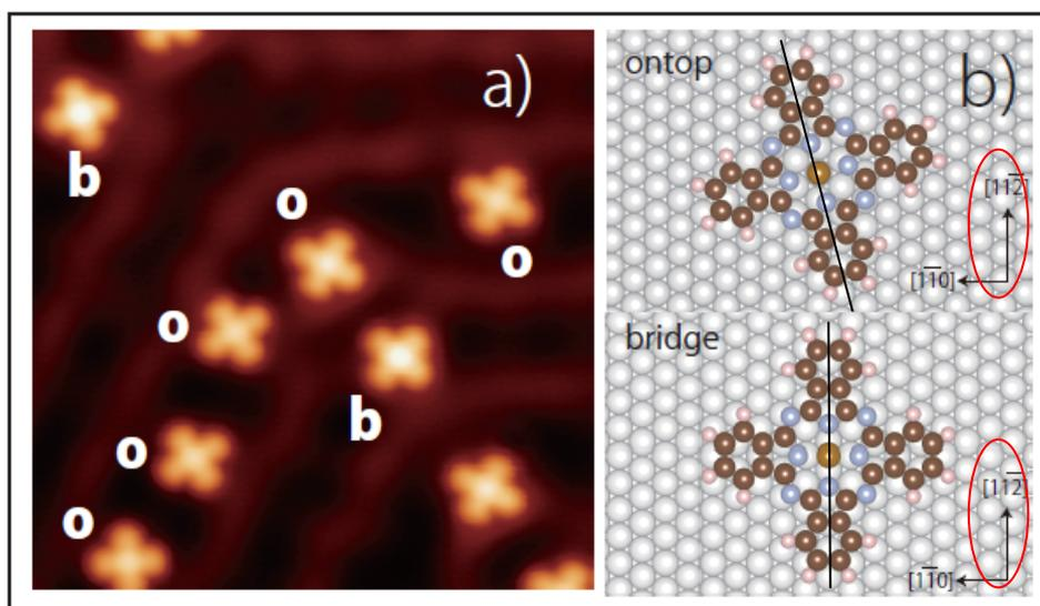
図1 金表面上に鉄フタロシアニン(FePc)分子を吸着させたときの構造
