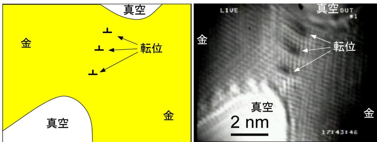
図 1 金のナノ接合のイラスト(左)と電子顕微鏡写真(右)。⊥マークは転位の位置を示す。金のナノ接合の中に転位が存在することが確認できる。
