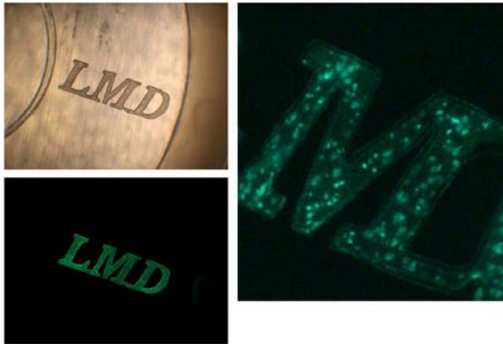
図1. レーザーで切り抜き回収された組織断片の例。神経細胞を緑色蛍光色素で標識してある。研究者の思い通りの形で組織断片を切り抜くことができ、なおかつ、回収された組織にレーザー光のダメージが無いことを示している。
