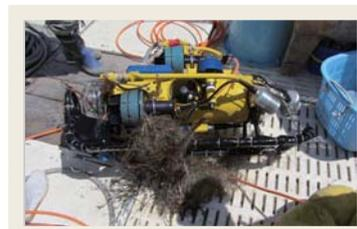
刺し網をプロペラにかみ込んだ遠隔操縦式カメラロボット
