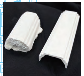
↑従来使われていたモルタルの天井材(左)と今回の改修で使われたGRGの天井材を持ち比べると、差は歴然。講堂の屋根は従来の7分の1〜6分の1まで軽量化されました。
