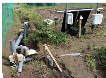
図3 現地の畑に設置した用水量、濁度計測定システム。福島県飯舘村の試験水田で実施している。
