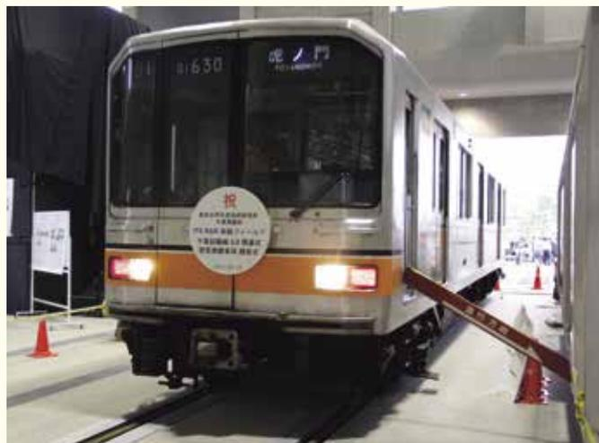
銀座線車両も走れる全長333mの標準軌道が敷設されています。
