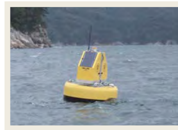
大槌湾に係留設置した水質プロファイリングブイ。ブイで計測しているデータは同時に設置した波浪ブイのデータとあわせてインターネットでリアルタイムに公開する予定。
