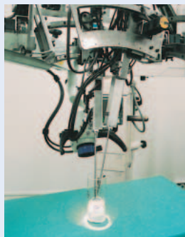
微小血管の縫合のためのスレーブマニピュレータ
