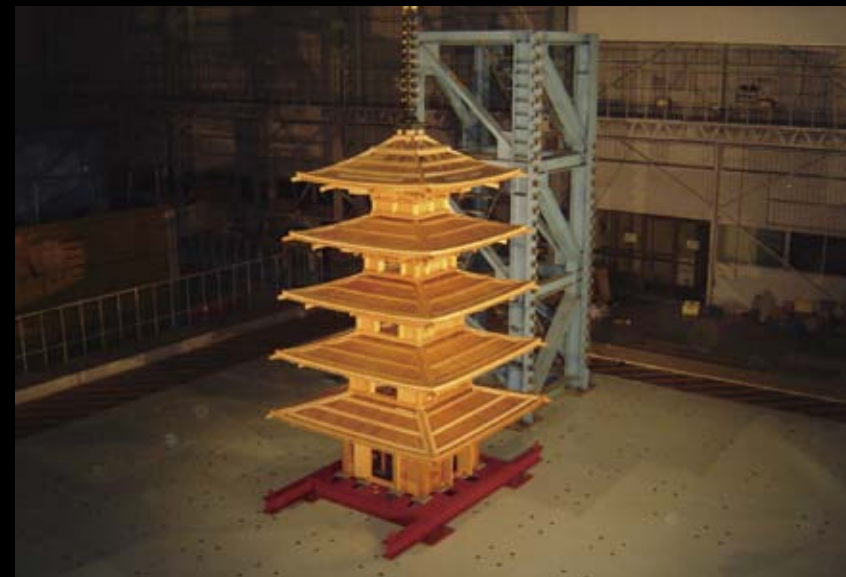
五重塔の原理を説明する五重塔振動台実験
