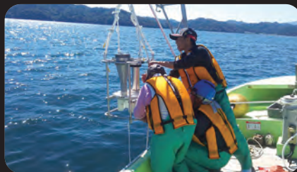
大槌湾に3か月ほど係留していたセジメントトラップを回収の様子。
