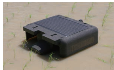
雑草が育ちにくい環境を作り、除草剤に過度に頼らない稲作に貢献する「アイガモロボ」。太陽光パネルで発電して自走できる。2025年3月に販売を開始する新型機は、低価格化、低重量化を実現し、中山間地域の狭い水田でも使いやすいものとなった。
