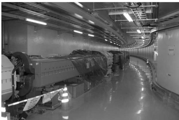
50GeVシンクロトロン内部に設置された電磁石
