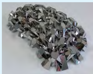
板金による自由形状折紙デモンストレーション
