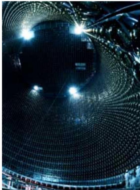
は、水の電子と反応し微弱な光を出す性質があるので、増倍管群がニュートリノの出す光をキャッチして信号として伝え、どの方向からやってきたかを、距離と時間差からコンピューターがはじきだす。1日に観測されるデータは文庫本5万冊分にのぼるが、そのなかからみつけられるニュートリノは10個程度。つまり、ほとんどがノイズなのである。忍耐が必要とされる作業。戸塚所長は、「これを精確に把握することが、実験データの信憑性を高めるために重要なんです」と、24時間体制で見守るスタッフの地道な苦勞を語る。また、タンクの上の天井はプラネタリウムのようなドーム型になっていて、この上の深さ1,000メートルの岩盤を支えているのだが、「こうした岩の力学を考えたり、観測設備の設計をするのも、スタッフの大事な仕事なんですよ。」
