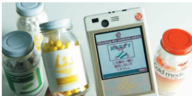
筆者が所長をしているユビキタス・ネットワークング研究所で、T-Engineアーキテクチャベースで開発した「ユビキタスコミュニケーター」。各種の通信方式をサポートする、個人に関するコミュニケーションの専用機。モノとの通信として、RFID やスマートICカードとのリーダーライタとして働く。
