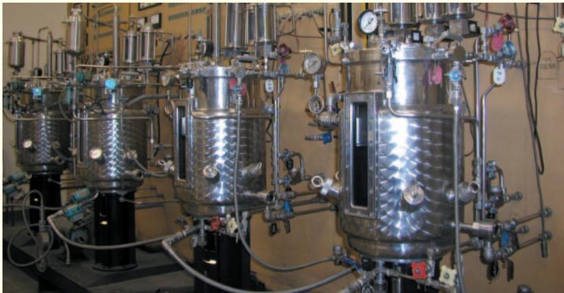
コンピューター制御可能な30リットルの組換え体封じ込め型培養装置
