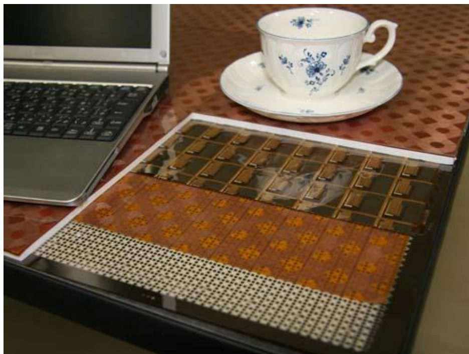
図2 テーブルに埋め込まれたワイヤレス電力伝送シート。上に置かれた電子機器の位置を検出し、その位置にワイヤレスで電力を送ることができる。（写真は製造したデバイスを撮影したものであるが、電気的な接続はされていない状態である。）
