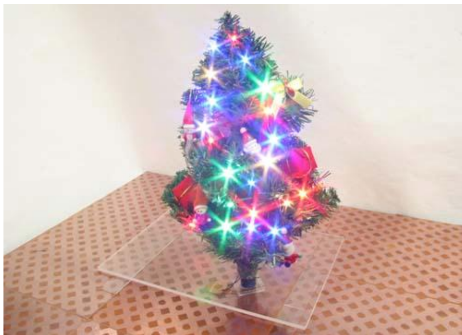
図3 ワイヤレス電力伝送シートを用いて、ガラス板上のクリスマスツリーを点灯。大きな電力がワイヤレスで発光ダイオードに供給されている。(デモ実験の写真)
