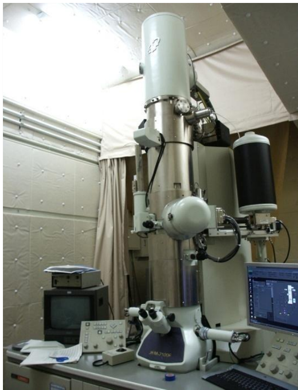
走査透過型電子顕微鏡 (STEM) 分解能 < 1 オングストローム ( \text{\AA} )
