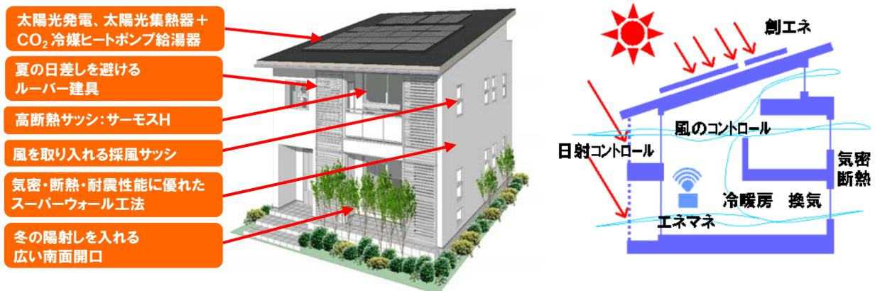
■実験住宅のイメージ 空気の流れをシミュレーションした開口設計など、随所に工夫を取り入れてプランニング。
