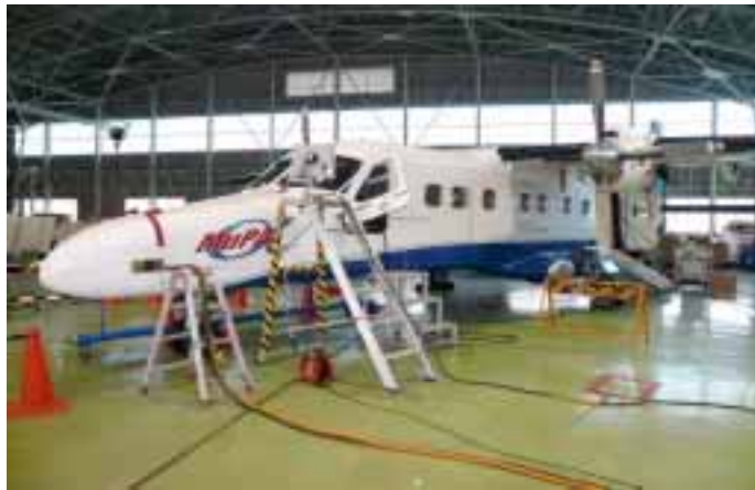
実験用航空機(MuPAL- \alpha )による地上シミュレーション試験 (JAXA)
