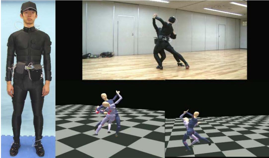
図：実現したサイバーコピースーツと再構成された動作例.
