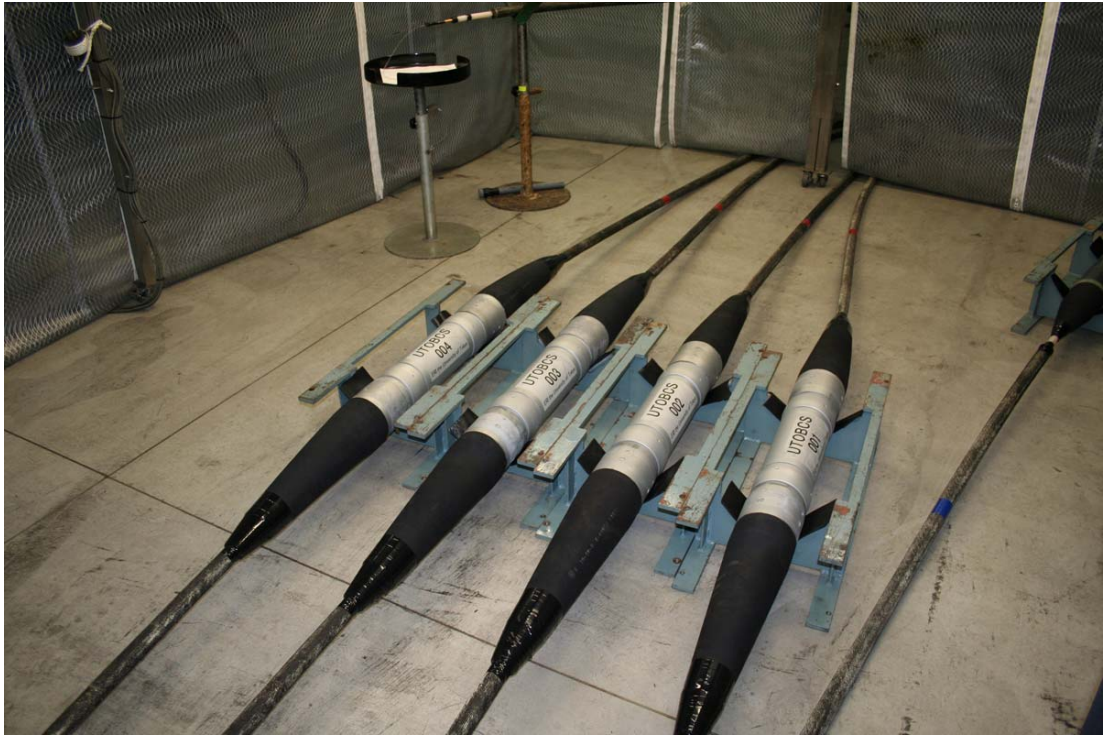
図3 地震動を感じる地震計の外観。直径は約15cm、長さは、黒い部分を含めて約1.5m。接続されている海底ケーブルは、直径4.3cmで、外側は鋼鉄線で保護されている。中には、光ファイバーと電力を供給する金属線が入っている。
