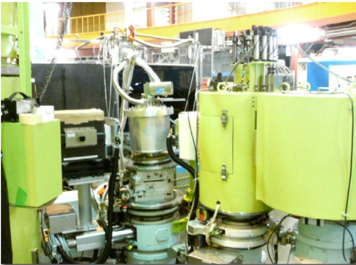
図 4：中性子非弾性散乱分光器の一つである日本原子力研究開発機構 JRR-3 研究用原子炉に設置された東大物性研所有の GPTAS 分光器。
