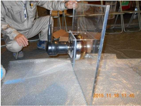
図3. 外水槽に取り付けられている8インチ径光電子増倍管（波長変換板付き）
