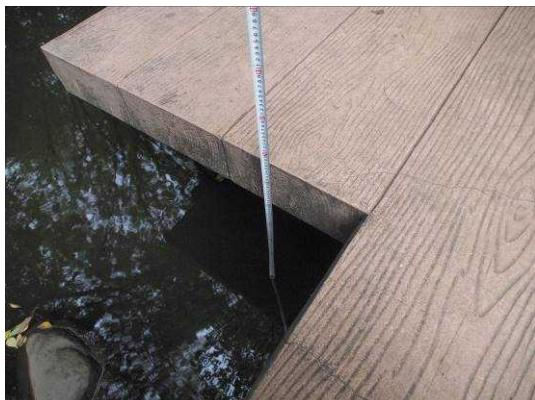
写真 4-9 擬木橋の水位計測
