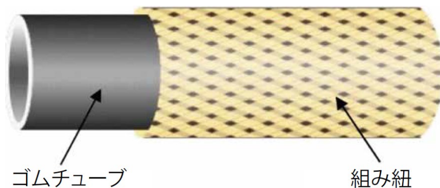
図1：マッキベン（McKibben）型人工筋肉の模式図
