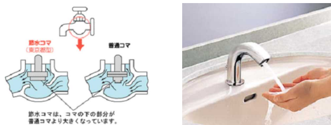
図 1 5 節水型水栓（左：節水コマ、右：自動水栓）
