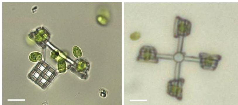
図1 本研究で作製したクラミドモナスで駆動するマイクロマシン。
