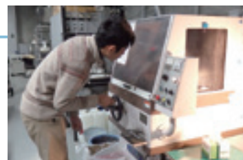
金属塊を高速精密切断機で加工
