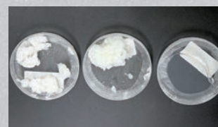
製紙用の針葉樹パルプ (左)、パルプをTEMPOで化学処理したTEMPO酸化セルロース (中央)。そのセルロースを水に分散させ、ミキサーなどで解繊処理してできた透明なゲル状のCNF (右)。
