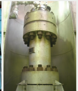
2003年に大学では世界で初めて導入された、高温高圧の水を利用した超臨界水酸化法による有機系実験廃液の処理装置(柏キャンパス)
