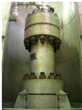
超臨界水酸化法による処理設備 2003年に大学では世界で初めて導入された、高温高圧の水を利用した超臨界水酸化法による有機系実験廃液の処理装置（柏キャンパス）
