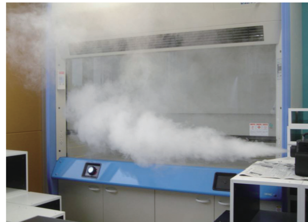
スモークマシンを使った気流の可視化実験
