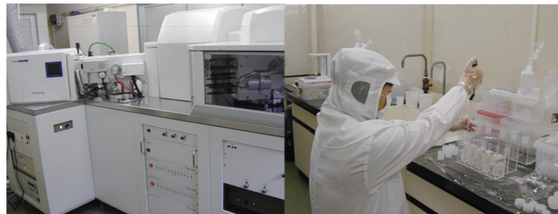
左：地震研究所のICP質量分析計 右：炭酸塩鉱物から微量のウランやトリウムを分離・精製するためのクリーンルーム。このような実験施設や質量分析計は国内では数少なく、今後の環境研究のためには設備の拡充が必要である
