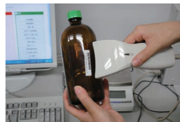
試薬びんごとにバーコードを発行し、びんに添付して管理します
