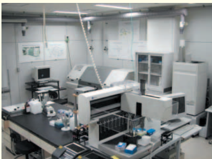
蛋白質解析室の主力機 MALDI-TOF/TOF 型質量分析計（中央奥）と周辺機器
