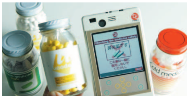
筆者が所長をしているユビキタス・ネットワークング研究所で、T-Engineアーキテクチャベースで開発した「ユビキタスコミュニケーター」。各種の通信方式をサポートする、個人に関するコミュニケーションの専用機。モノとの通信として、RFID やスマートICカードとのリーダーライタとして働く。
